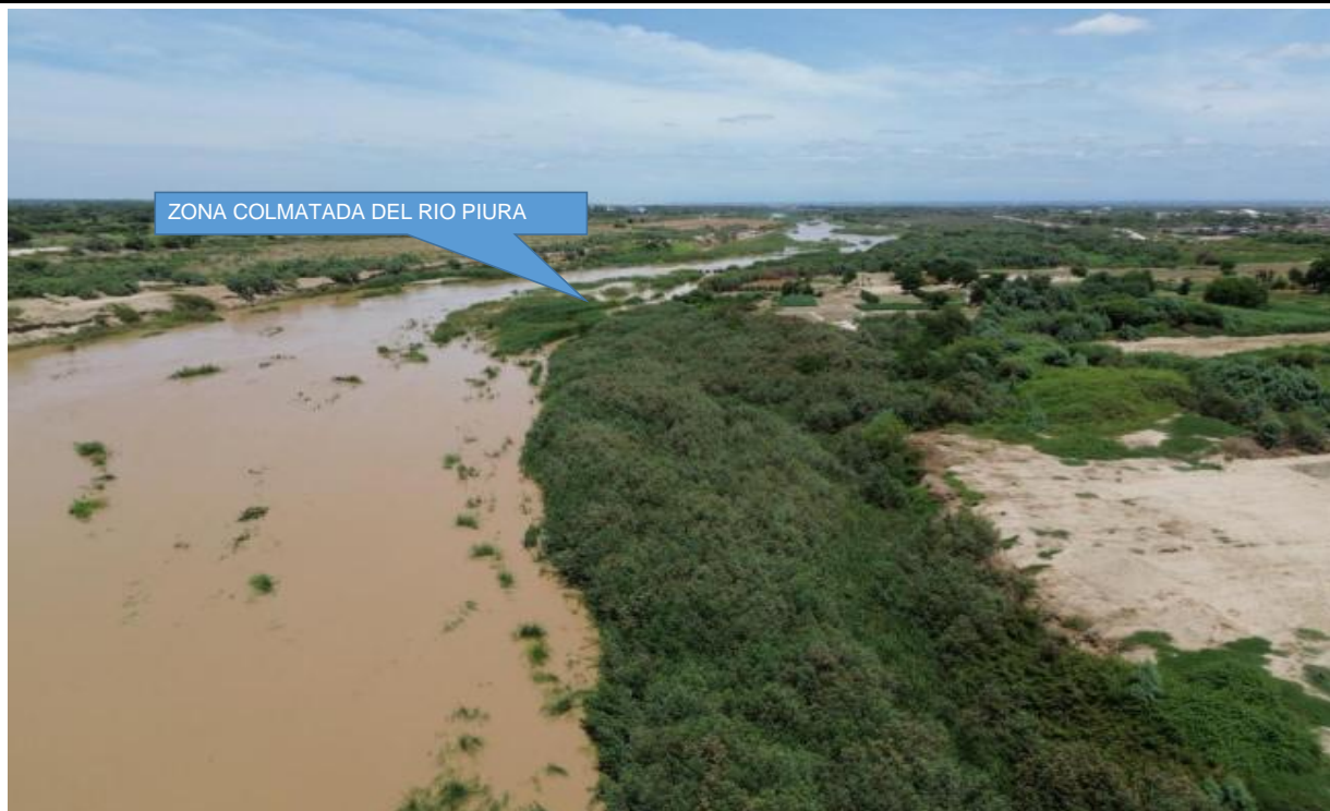
Figura N° 01: Se observa la colmatación del cauce del río Piura
